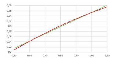
Si l'on change les deuxième et troisième points de l'exemple par les valeurs y=0,21 et 0,35, la courbe d'interpolation (en rouge) essaie toujours de maintenir le passage de la courbe par les points donnés et prend une forme plutôt ondulée. A titre de comparaison, approximation de régression linéaire à nouveau (en vert).
