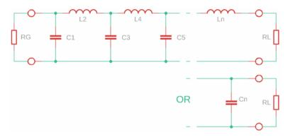
Le filtre passe-bas passif est constitué de condensateurs alternatifs connectés en parallèle et de bobines connectées en série, numérotées de 1 à n. Pour un « n » pair, le filtre se termine par une bobine, pour un « n » impair, il se termine par un condensateur. La résistance RG représente la résistance interne du générateur de signal. La résistance RL est la résistance d'entrée de la charge. Le programme suppose que les valeurs des deux résistances correspondent, RG = RL = R.
