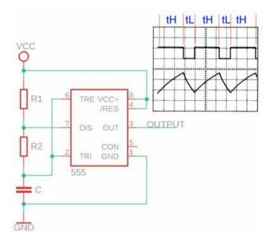
temps de charge (sortie à l'état HIGH) tH = ln(2) \* (R1 + R2) \* Ctemps de décharge (sortie à l'état LOW) tL = ln(2) \* R2 \* C
