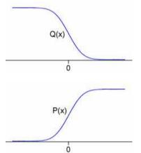
L'intégrale (aire) de la courbe à partir du point limite spécifié Q(x) est appelée distribution gaussienne complémentaire, ou également fonction Q.
