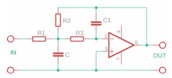
Données connues : facteur de crête 'alpha', gain 'A' en dB, fréquence de coupure 'F' en Hz, C1 en farads. Le programme calcule C, R1, R2 et R3.
