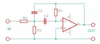
Données connues : bande passante de 3 dB de la bande "B" en Hz, gain moyenne bande "A" en dB, fréquence moyenne bande "F" en Hz, capacités C1 et C2 en farads. Le programme calcule les valeurs de R1, R2 et R3.
