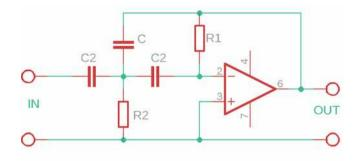
Données connues : facteur de crête « alpha », gain « A » en dB, fréquence de coupure « F » en Hz, C2 en farads. Le programme calcule C, R1 et R2.
